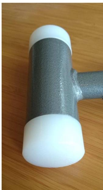
お使いになるハンマー（金槌）は、鉄製よりも左写真のようなプラスチック製の方が傷つかず安心してお使い頂けます。
