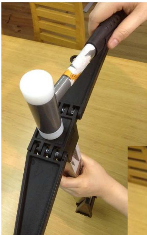
固定パーツを入替えした後、今度は上からハンマーで叩くことによりスチールとプラスチックの凹凸部分が食い込みロックされます。
