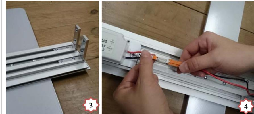
3. コーナーコネクターはΦ3mmの六角レンチで写真のように取付けます。
