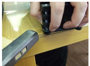
最後に、最初に外したストッパーをピンの溝にハンマーで叩いて固定します。
