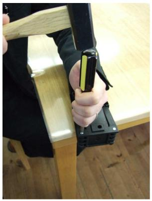
脚を上向けにし、テーブルの端に置きます。 ドライバーをピンにあて、ハンマーで上から 打ち、ピンを外します。
