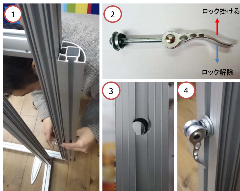
図2: ツイストロック解除 (OPEN) の状態で差し込み、ロック (CLOSE) します。 図3、4: ツイストロックはコーナーポストと接続してプロファイルの溝に合わせます。 図5: コーナーポストと接続するプロファイルは天地をぴったり合わせることがポイントです。
