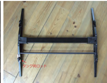
ベースの上にタンク用ロッドをセットします。
